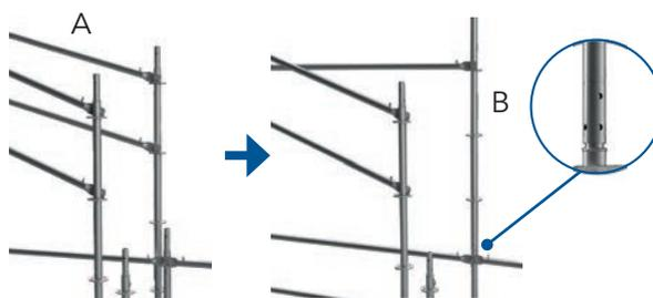
2. Dopo aver assicurato il tutto mediante l'inserimento di un perno di sicurezza, si posiziona il secondo montante verticale (C) e si monta la traversa.
