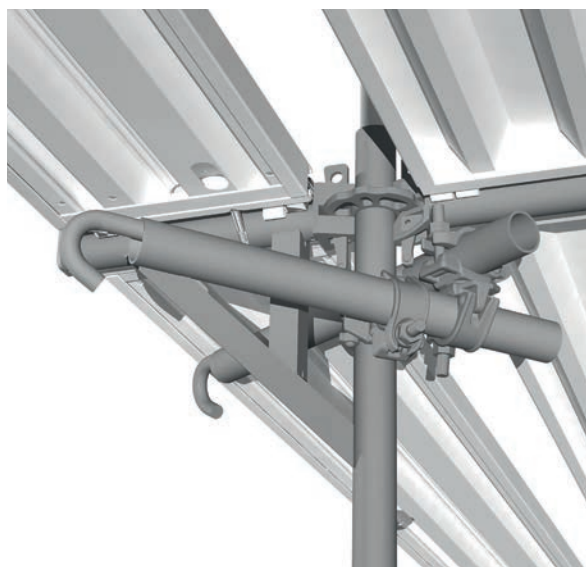
Figure 40 : Amarrage en V (configuration avec consoles intérieures)
