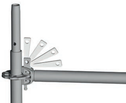
Figure 12 : Installation d'un coin dans un trou du disque perforé
