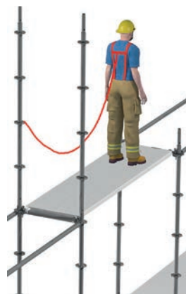
Figure 61 : Points de fixation possibles sur montant continu
