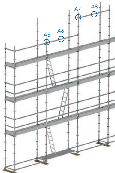
Figure 65 : Points de fixation admis A5 à A8
