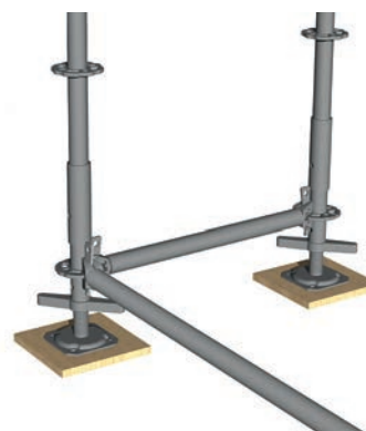
Figure 23 : Semelle de répartition des charges constituée de madriers
