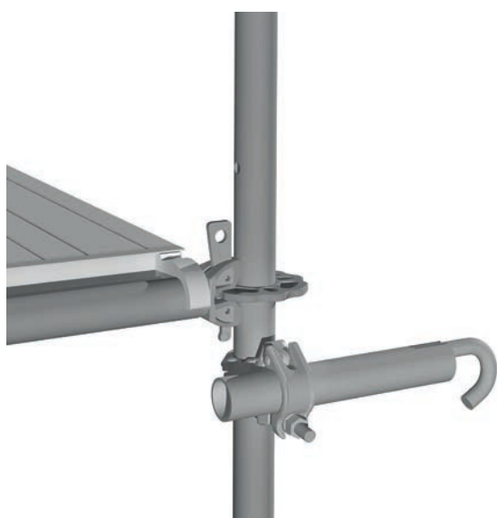
Figure 5 : Détails de jonction d'échafaudage, avec rails de support et ancrage d'échafaudage
