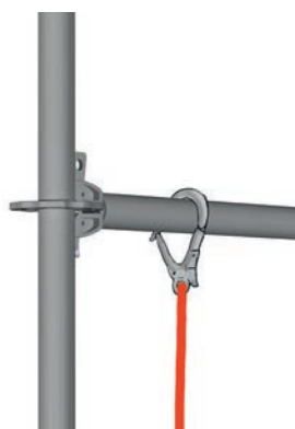
Figure 62 : Points de fixation possibles sur rail
