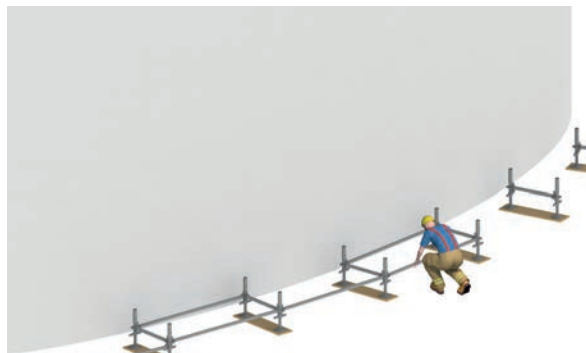
Figure 53 : Échafaudage d'un réservoir circulaire
