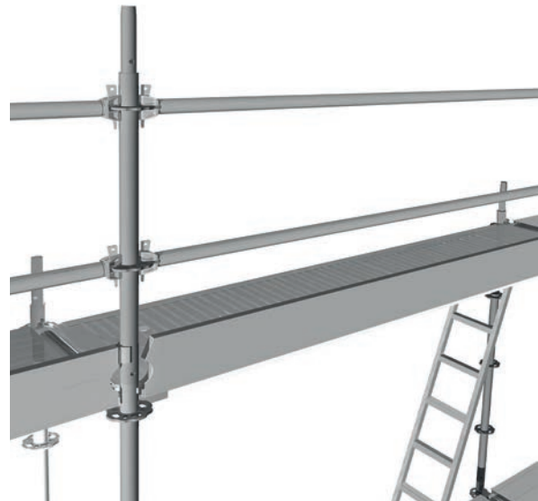
Figure 36 : Élément terminal supérieur de l'échafaudage avec garde-corps
