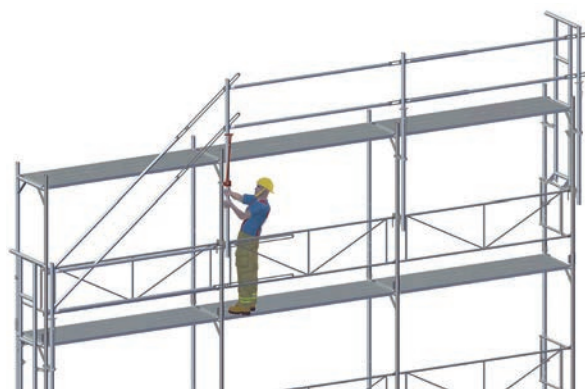
Figure 29 : Surélévation du système de sécurisation du montage «Universal»
