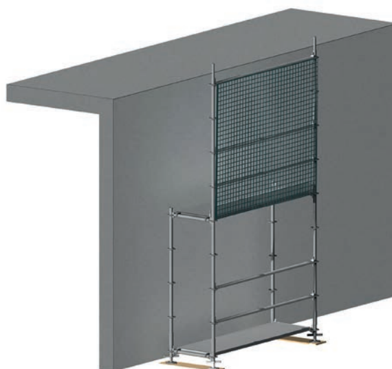
Figure 42 : Cloison de protection, façonnage avec tubes de renfort sur le goujon à hauteur de plateau, montage de la cloison de protection
