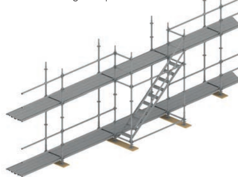
Figure 34: Montage de garde-corps d'escalier et de lisses comme protection latérale.
