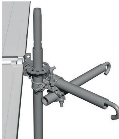
Figure 39 : Amarrage en V (configuration de base)
