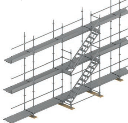
Figure 35: Montage d'une barre d'escalier au niveau supérieur d'échafaudage.
