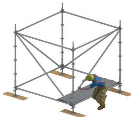
Figure 47 : L'échafaudage à chevalets est renforcé sur les quatre côtés par des diagonales verticales.
