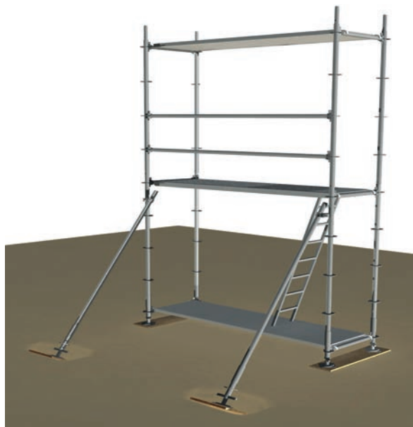
Figure 3 : Exemples d'une sécurité antibasculement temporaire du premier niveau lors du montage d'un échafaudage de façade
