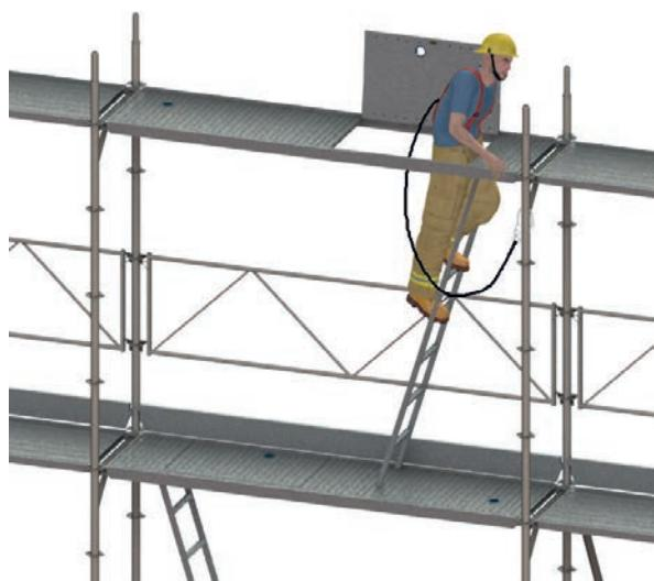
Figure 21 : sécurisation avec l'EPI avant de monter sur la couche supérieure de l'échafaudage
