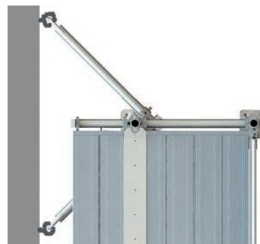
Figure 25 : Ancrage en V, configuration avec consoles intérieures
