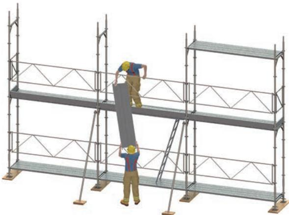
Figure 12 : exemple d'une protection temporaire contre le basculement du premier niveau de l'échafaudage
