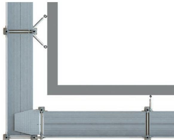
Figure 26 : Ancrages dans les angles
