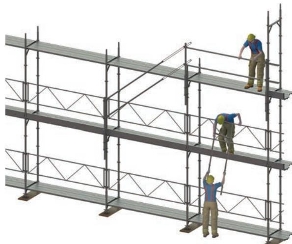
**Figure 13 :** Exemple de réception de matériel et de montage d'échafaudage sur la couche supérieure de l'échafaudage
