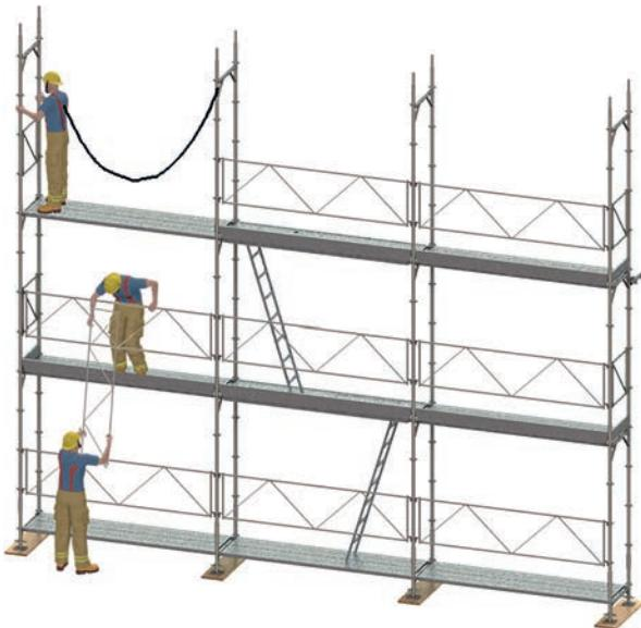
Figure 20 : exemple de montage en protection de l'EPI sur la couche supérieure de l'échafaudage.
