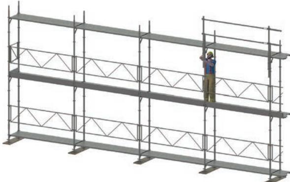
Figure 14 : Montage du MSG dans le champ d'ascension à partir de la position sécurisée
