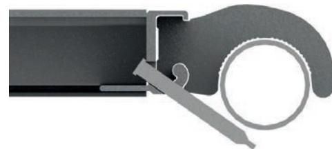
Figure 7: Protection contre le vent fermée
