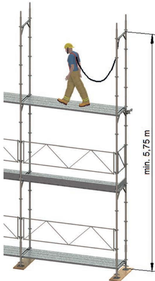
Figure 19 : hauteur minimale du point d'ancrage de l'EPI
