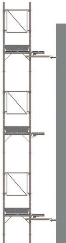
Figure 41 : position libre d'un échafaudage comme état intermédiaire lors de la construction d'un bâtiment
