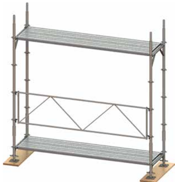
Bild 8: Fertig montiertes erstes Gerüstfeld
