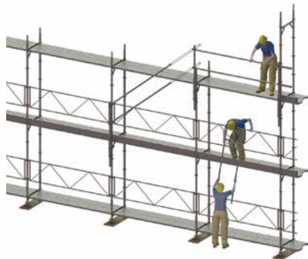
Bild 13: Beispiel für die Materialannahme und Gerüstmontage auf der obersten Gerüstlage
