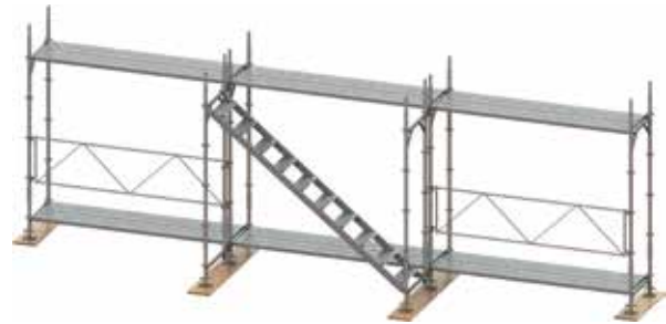
Bild 10: Treppenaufstieg bis zur ersten Gerüstlage
