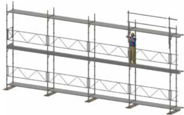
Bild 14: Montage des MSG im Aufstiegsfeld von der gesicherten Lage aus
