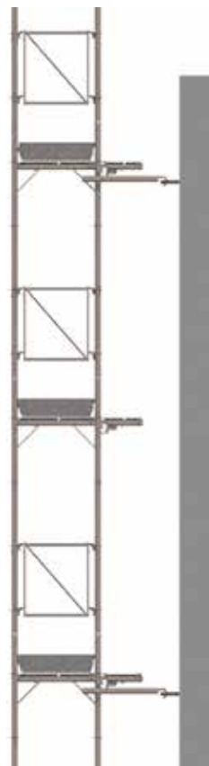
Bild 41: Freistehende Gerüstlage als Zwischenzustand beim Errichten von Gebäuden
