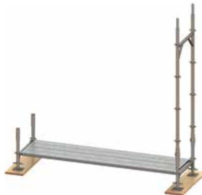
Bild 15: Aufstecken eines Gerüststrahmens
